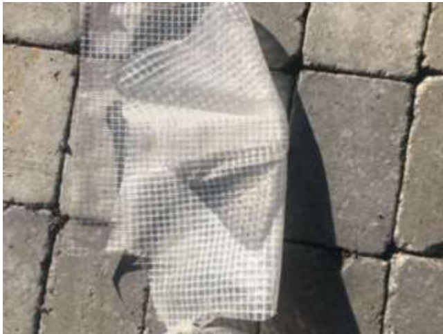
Väderskydd för ställning (vinterväv/ställningsduk)
